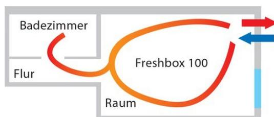
Die Freshbox 100 WiFi eignet sich insbesondere für 1-Zimmer-Wohnungen, da man dank einer Anschlussmöglichkeit mit einem einfachen Rohrsystem einen zweiten Raum mit entlüften kann. Der hohe Wärmerückgewinnungsgrad von bis zu 96 % machen diese Anlage auch für Büroräume äußerst interessant.
